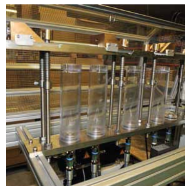
Chaque boîtier subit un test de résistance à la pression Each unit undergoes a pressure test
