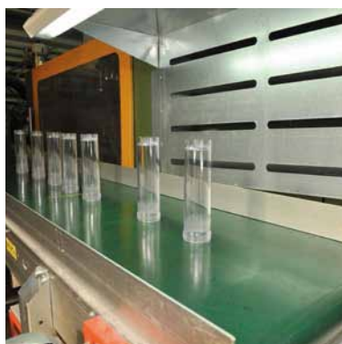
Les boîtiers sortis d'injection. Ditybox injection outlet
